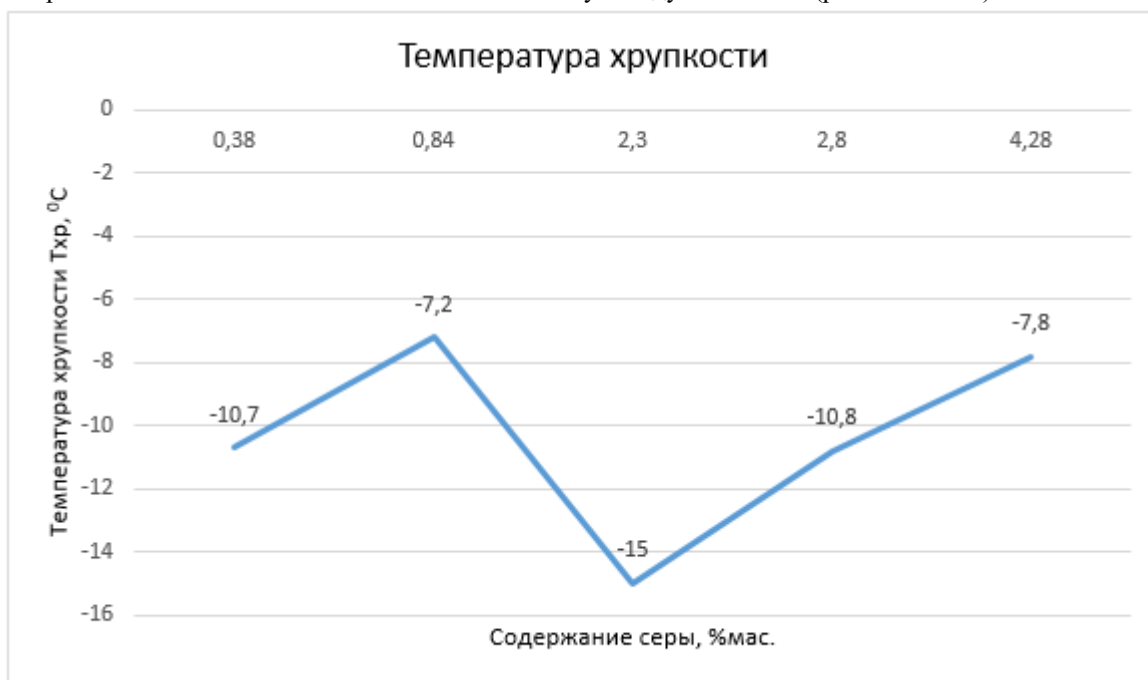
Рис. 3. Зависимость температуры хрупкости битума от содержания серы в сырье
