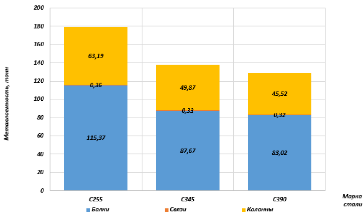
Рис. 3. Графики зависимости металлоемкости каркаса здания от марок применяемых сталей
