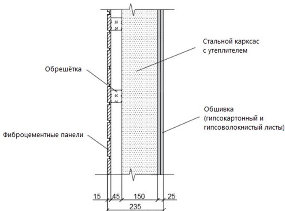
Рис. 3. Конструкция стены ЛСТК
