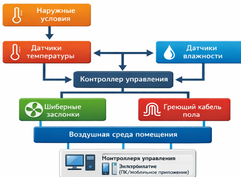
Рис. 1. Структурная схема комбинированной автоматизированной системы микроклимата
