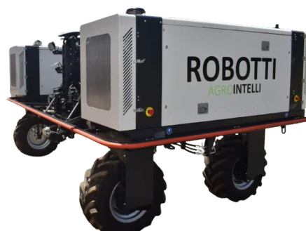
Рис. 2 Универсальная роботизированная платформа AgroIntelli Robotti
