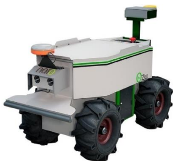
Рис. 1 Универсальная роботизированная платформа Naïo Oz
